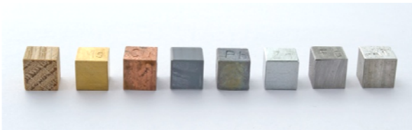
1 Satz Würfel zur Dichtebestimmung (76500)
